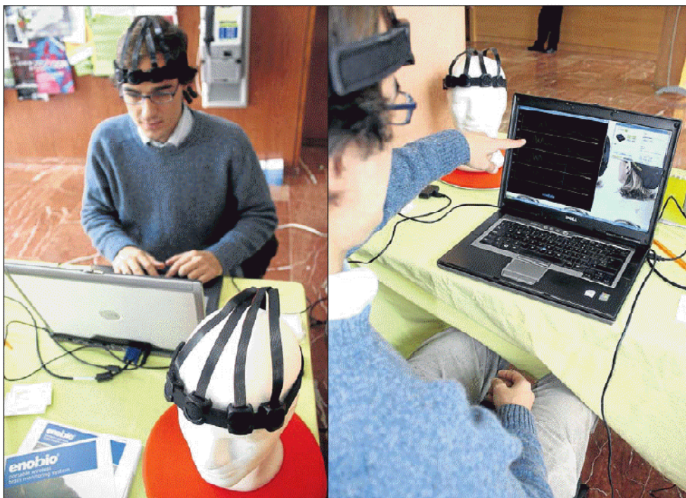
CASCOS PARA LEER LA ACTIVIDAD CEREBRAL. Alejandro lleva puesto uno de los dispositivos que permite al ordenador leer la actividad cerebral y la ocular. Por ejemplo, cuando guía un ojo, se eleva un pico en la pantalla, como señala con el dedo. Esta interacción tiene mil aplicaciones: en salud, en el campo de los videojuegos, en seguridad vial, en accesibilidad... Fotos:M.F.
